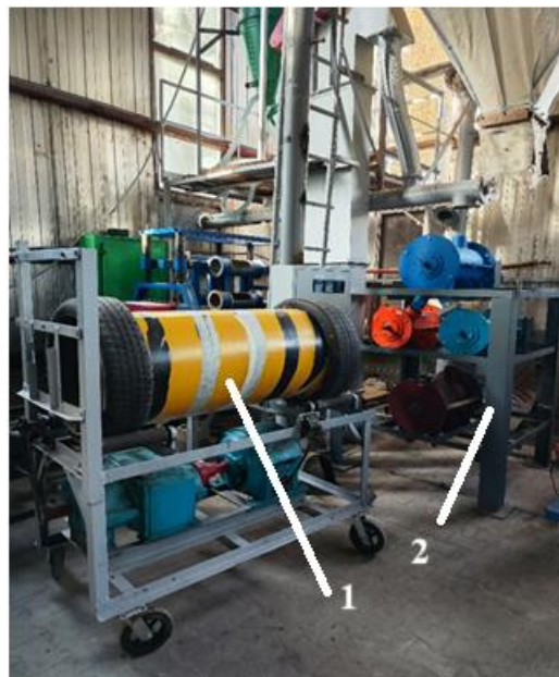
Рисунок 5.8. Общий вид опытно-промышленного технологического модуля с барабанно-винтовым агрегатом (1) и смесителем рециркуляционного действия (2)
