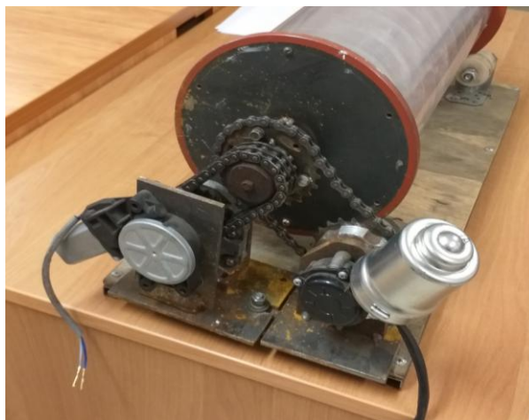
Рисунок 3.4. Вид на мотор-редукторы приводов и трансмиссию внешнего барабана
