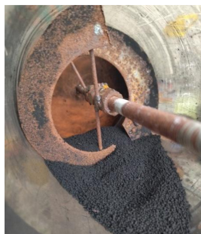
Рисунок 2.6. Схема установки двухзаходных винтовых лопастей (а) и процесс упрочнения микрогранулята в модельной установке (б)
