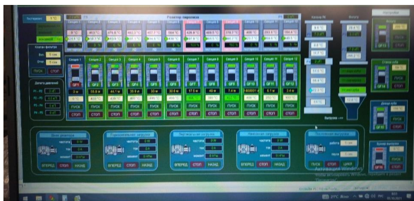
Рисунок 5.3. Монитор пульта управления оператора для визуализации параметров технологического процесса
