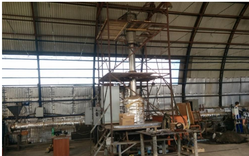
Рисунок 5.2. Опытно-промышленная установка низкотемпературного термолиза, производительностью Q=50 кг/ч. Геометрические параметры: длина – 12.0 м.; ширина – 1.0 м., высота – 3.0 м., диаметр реактора – 0.1 м.
